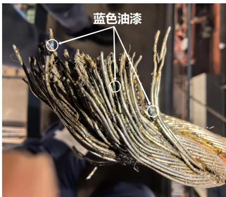
图 9 起升钢丝绳断口
