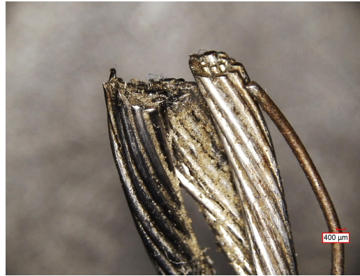
图 22 镜下整根钢丝绳断口
