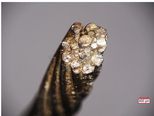
图 23 镜下单股钢丝绳断口
