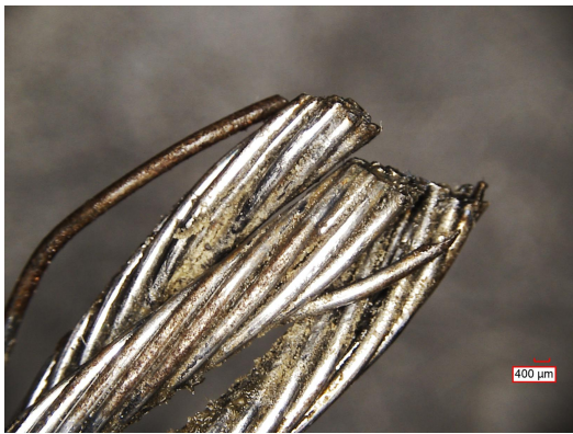
图 21 镜下整根钢丝绳断口
